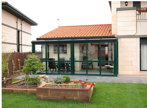
Sistema constructivo para la realización de verandas y techos fijos en aluminio con vigas tubulares, con posibilidad de adaptarse a cada necesidad. Sistema completo con rotura de puente térmico, con líneas de remate limpias y sencillas.
