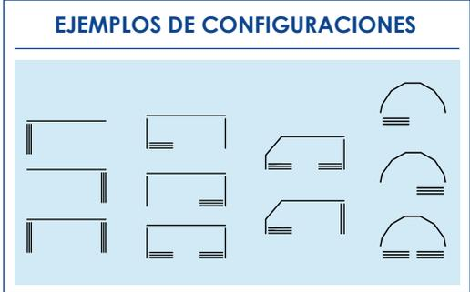
El sistema seeglass le permitirá deslizar las hojas por cualquier disposición geométrica, realizar aperturas exteriores/interiores, accionamientos interiores/exteriores, tramos fijos con posibilidad de limpieza, etc.
